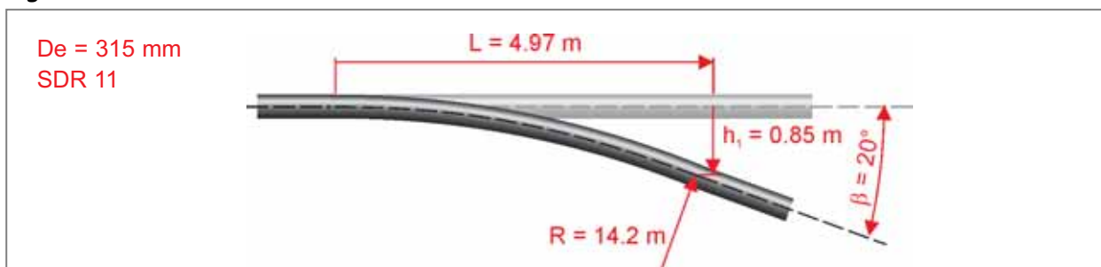
Figura 20.3. Realizzazione della curvatura richiesta
