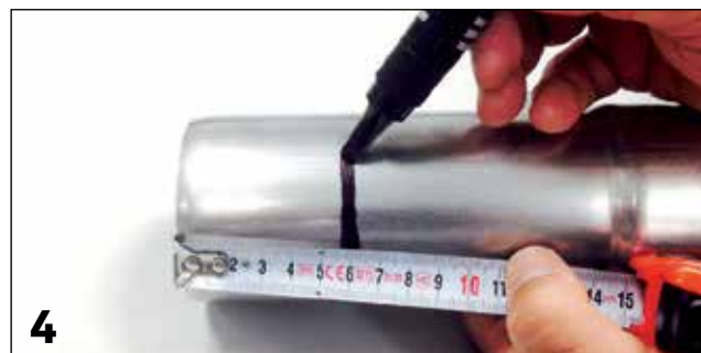
4 Marcatura quota d'innesto / Marking the insertion's depth
