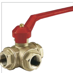
Valvola a sfera femmina a tre vie PN40, manovra a L. 3 outlets female ball valve PN40, L-handle. Válvula de bola hembra de 3 vías PN40, maniobra en L
